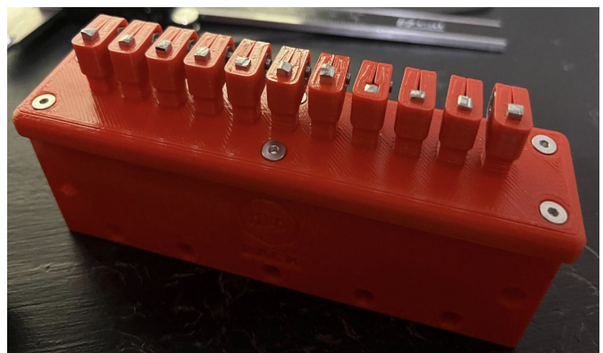
Figure 16. Silicon pour prototype cast model.
